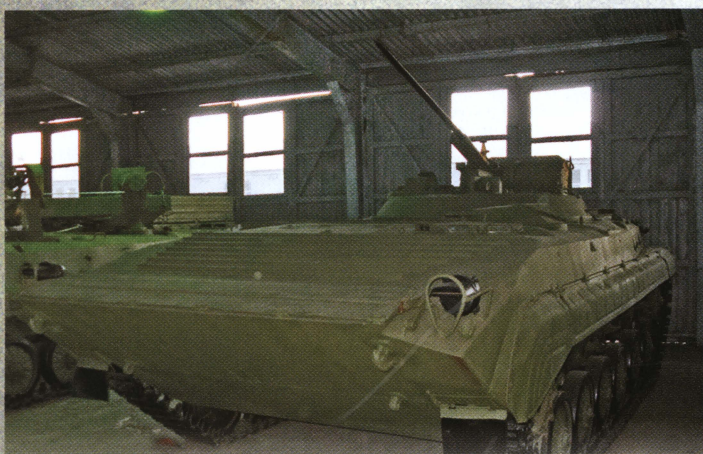
Опытный образец БМП Курганского завода «объект 680» с вынесенной 30-мм автоматической пушкой в экспозиции музея БТВТ в Кубинке.
