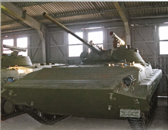
Опытный образец БМП Курганского завода «объект 681» с 73-мм пушкой «Зарница», музей БТВТ в Кубинке.
